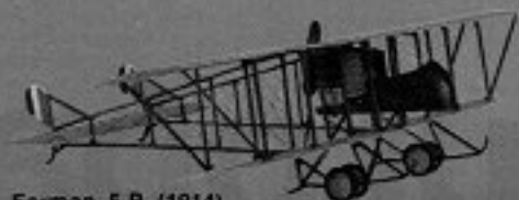
Farman 5 B (1914). Primo modello, con motore FIAT A 10, costruito su licenza francese. Velocità: 100 km. orari.
