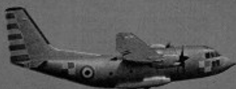
FIAT G 222 (1970). Il più recente modello Fiat è un turboprop bimotore da trasporto civile e militare a decollo corto. Velocità massima: 520 km. orari.
