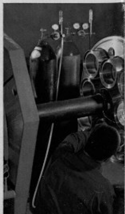
Saldatura di componente per reattore nucleare in acciaio inossidabile austenitico.
