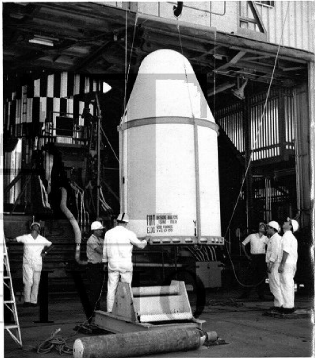
Si sta issando la parte terminale dell'EUROPA I: gli scudi termici che formano l'ogiva del lanciatore, con la scritta Fiat Aviazione. I materiali italiani sono stati trasportati da Torino a Woomera (Australia) con un velivolo apposito. Il nome «woomera» con il quale è stato battezzato il poligono di tiro, corrisponde a quello di uno speciale attrezzo con il quale gli indigeni lanciano le frecce. Il montaggio dei diversi stadi dell'EUROPA I ha richiesto quasi tre mesi.
