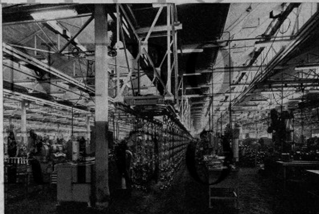
Una linea di lavorazione specifica per alberi a gomito vetture. Convogliatori aerei continui.
