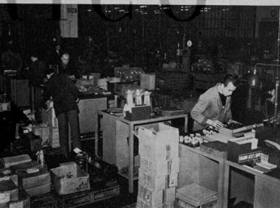
Un particolare del reparto accettazione del materiale proveniente da ditte fornitrici. Anche qui l'accertamento viene eseguito secondo il «metodo del campione». Si usano speciali tabelle, razionalmente elaborate sulla base di certi metodi matematici i quali hanno dimostrato come, in determinati casi, una piccola parte di una partita di merce, se prelevata con criteri appropriati, ha 99 probabilità su cento di rappresentare esattamente il tutto. Il controllo così eseguito molto spesso risulta anzi ancora più esatto di quello compiuto al 100%, perché è esente dai rischi di errori derivanti dalla noia e dalla stanchezza inevitabili nei lunghissimi collaudi.
