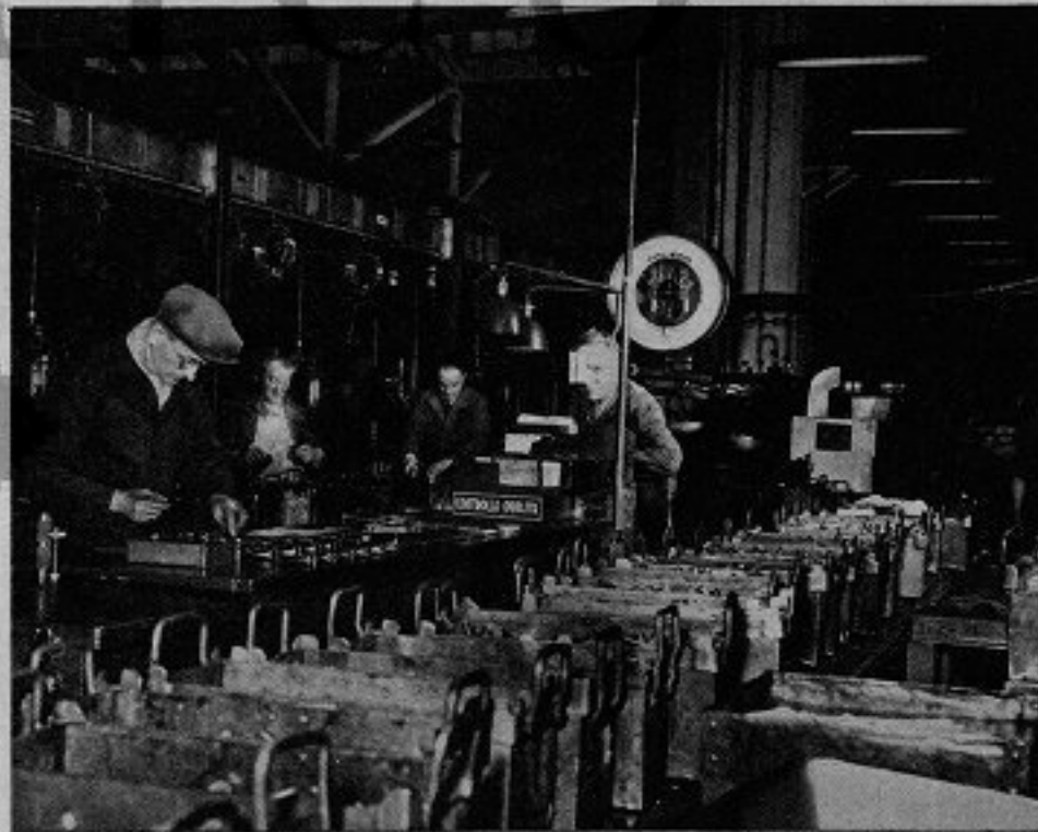
Nell'Officina 6: la bulloneria per le più disparate esigenze viene sottoposta al controllo di accettazione mediante un moderno sistema di campionatura doppia, secondo la tecnica del controllo di qualità. In primo piano a destra: Giuseppe Aviotti (un anziano Fiat con 32 anni di servizio), Carlo Bostico, Brunetto Brunacci e Remigio Turletti.
