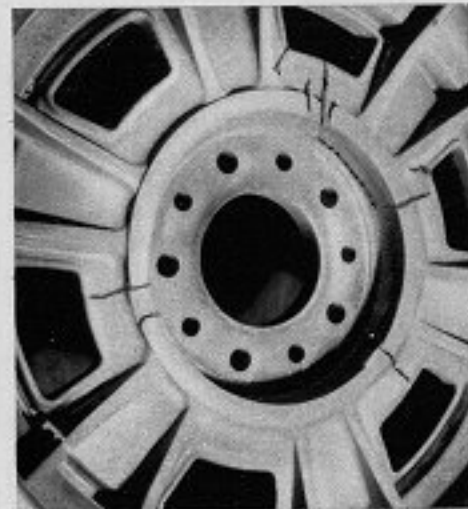
Fotografia di una ruota in lega leggera con cricche provocate da una prova di fatica, rese visibili mediante il liquido penetrante rosso sopra un fondo di polvere bianca.
