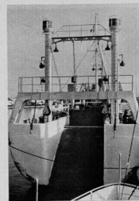
La poppa caratteristica delle moderne navi da pesca: il grande scivolo facilita l'alzata delle reti a bordo.
