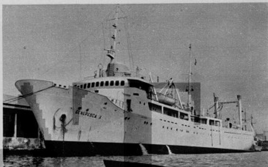
« Genepesca X » è la più recente unità della flotta. Adatta alla pesca in ogni latitudine, può lavorare e immagazzinare nelle stive frigorifere fino a 275 tonnellate di pesce ogni viaggio.
