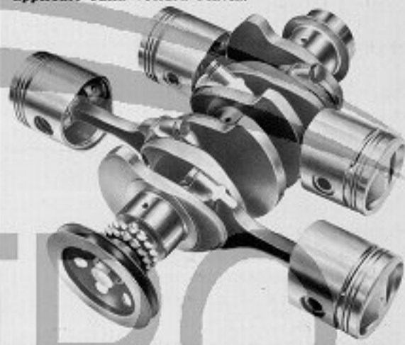
Gruppo propulsore e particolare dei quattro cilindri orizzontali contrapposti, applicato sulla vettura Flavia.
