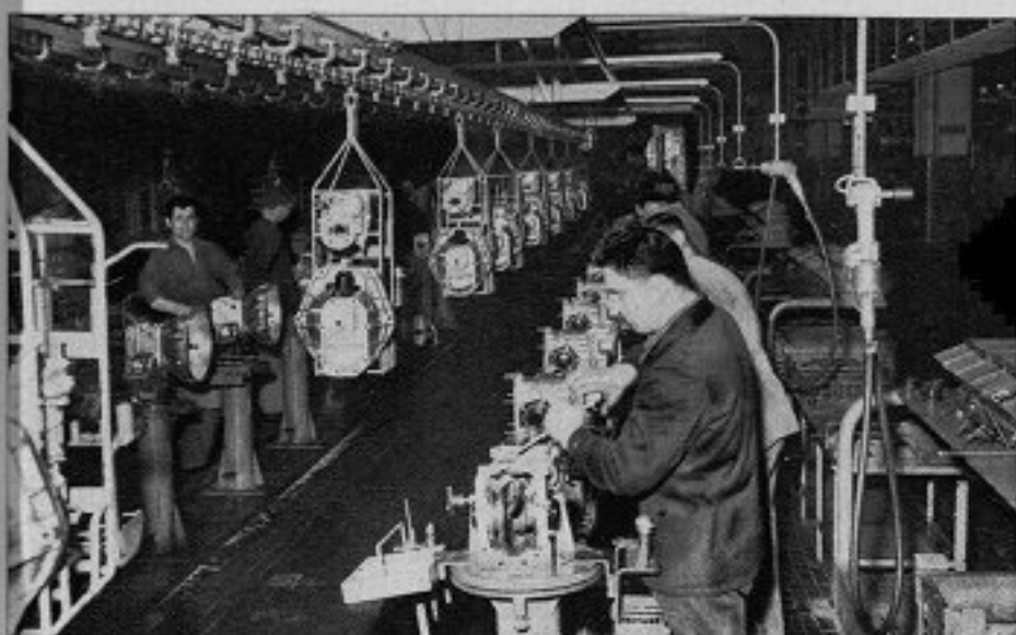
Ora si procede al montaggio della scatola del cambio e del differenziale: nelle 15 ore di due turni a questa linea se ne possono montare 600; la linea su trasportatore, di tipo modernissimo, è una delle molte particolarità che agevolano l'esatta e spedita esecuzione del lavoro, compiuto — qui come ovunque — da abili, esperti operai: Ferruccio Ostorero, Calza Giuseppe, Benvenuto Giovanni, Bianco Fortunato.
