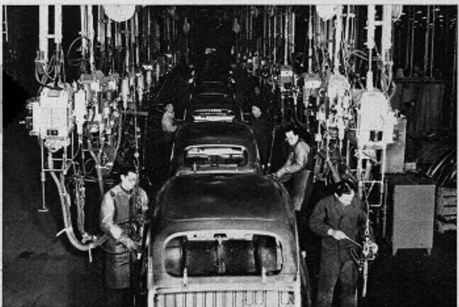
L'ossatura completa è stata messa assieme, al mascherone di montaggio; qui si completa l'opera di saldatura. Si tratta appunto di una linea di completamento. Nella foto: Enrico Giordano, Italo Bosio ed Emilio Meano.
