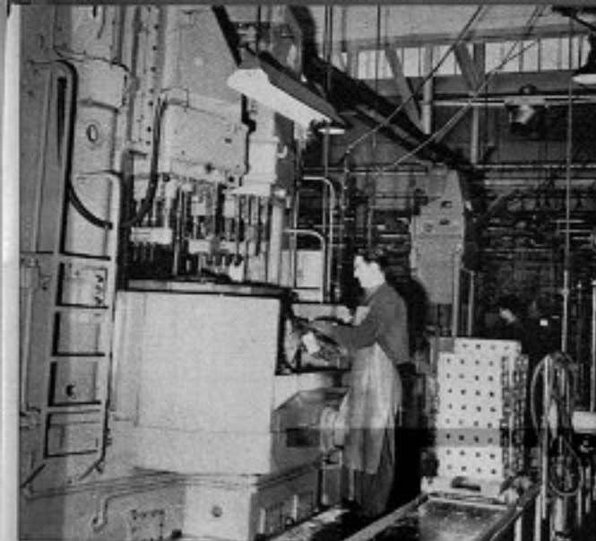
La lavorazione della testa cilindri è eseguita da trapanatrici multiple, di concezione modernissima, ideata e prodotta dalla stessa Fiat, appositamente per la «600». Sono complessi con unità di foratura multiple. Nella foto: Crema Romano e Acquisto Pietro, addetti macchina.
