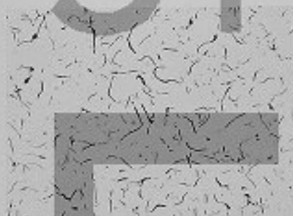
a) RG = 1,34 ; Sc = 0,80 - Grafite tipo A con distribuzione uniforme e senza orientazione preferenziale (ottima). Materiale di carica: boccato acciaio
