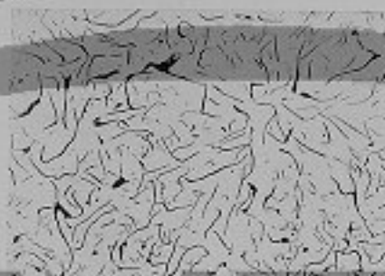
a) RG = 1,25 ; Sc = 0,99 - Grafite tipo A con distribuzione uniforme e senza orientazione preferenziale (ottima). Materiale di carica: sferidi lamiera
