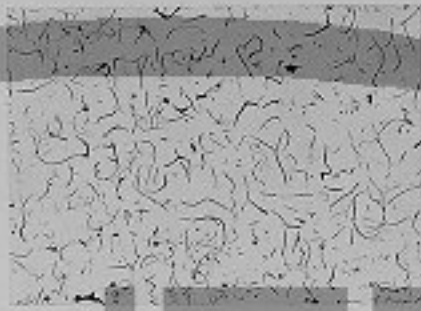
b) RG = 1,14 - Grafite tipo A con distribuzione abbastanza uniforme e senza orientazione preferenziale (buona)
