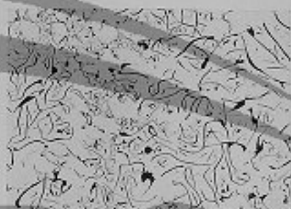
b) RG = 0,90 ; Sc = 0,95 - Grafite tipo A e tipo D (interdendritica) (coadente). Materiale di carica: acciaio molle
