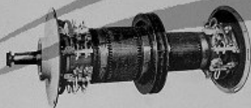
Fig. 14 - Rotore del gruppo eccitatrice-generatore ausiliario
