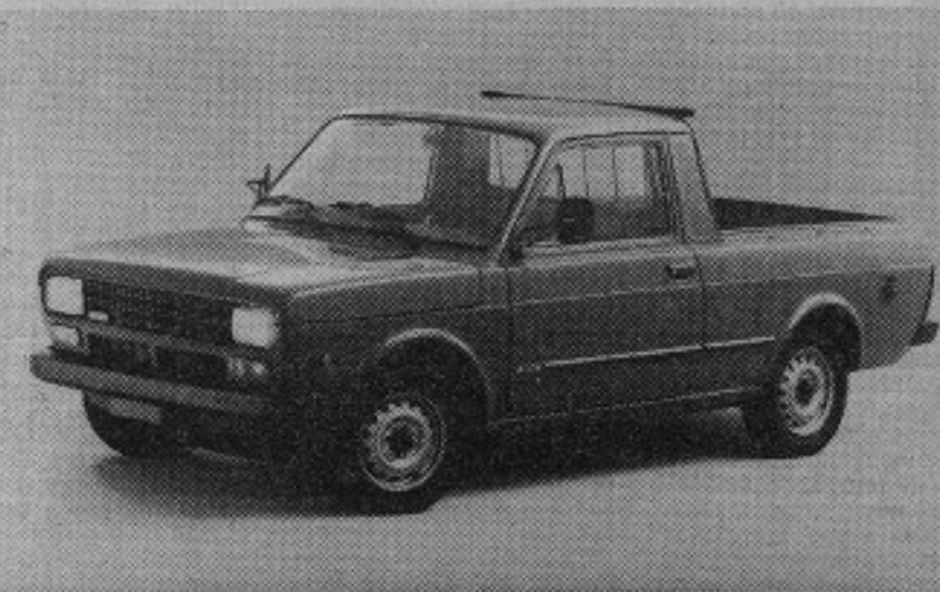
Il nuovo Fiorino Panorama offre le prestazioni delle vetture e quelle del mezzo da lavoro; i sedili posteriori sono infatti rivolti in senso di marcia. Sotto, il Fiorino nella nuova versione pick-up: sospensioni e struttura irrobustite per carichi di 500 chilogrammi
