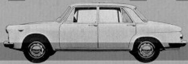
La Flavia, ha motore a 4 cilindri orizzontali contrapposti di 1500 cmc; rispetto all'Aprilia, a parità di cilindrata ha una potenza di oltre il 60 per cento superiore. La carrozzeria è per sei persone. Il passo è di mt 2,65; la carreggiata anteriore di mm 1300 e posteriore di mm 1280, la lunghezza di mt 4,580 e la larghezza di mt 1,610.
