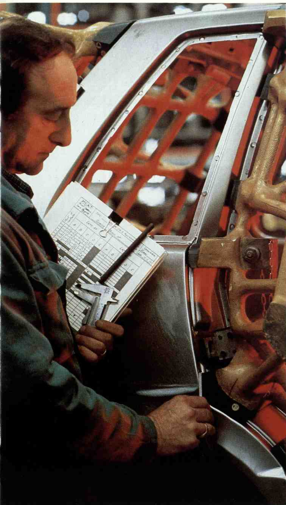
A sinistra, Mirafiori Carrozzeria: controlli sul calibro per i vani della scocca.
