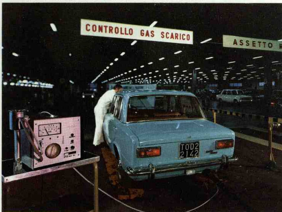
Stazione diagnosi per Filiali Fiat. Verifica emissione dell'ossido di carbonio.
