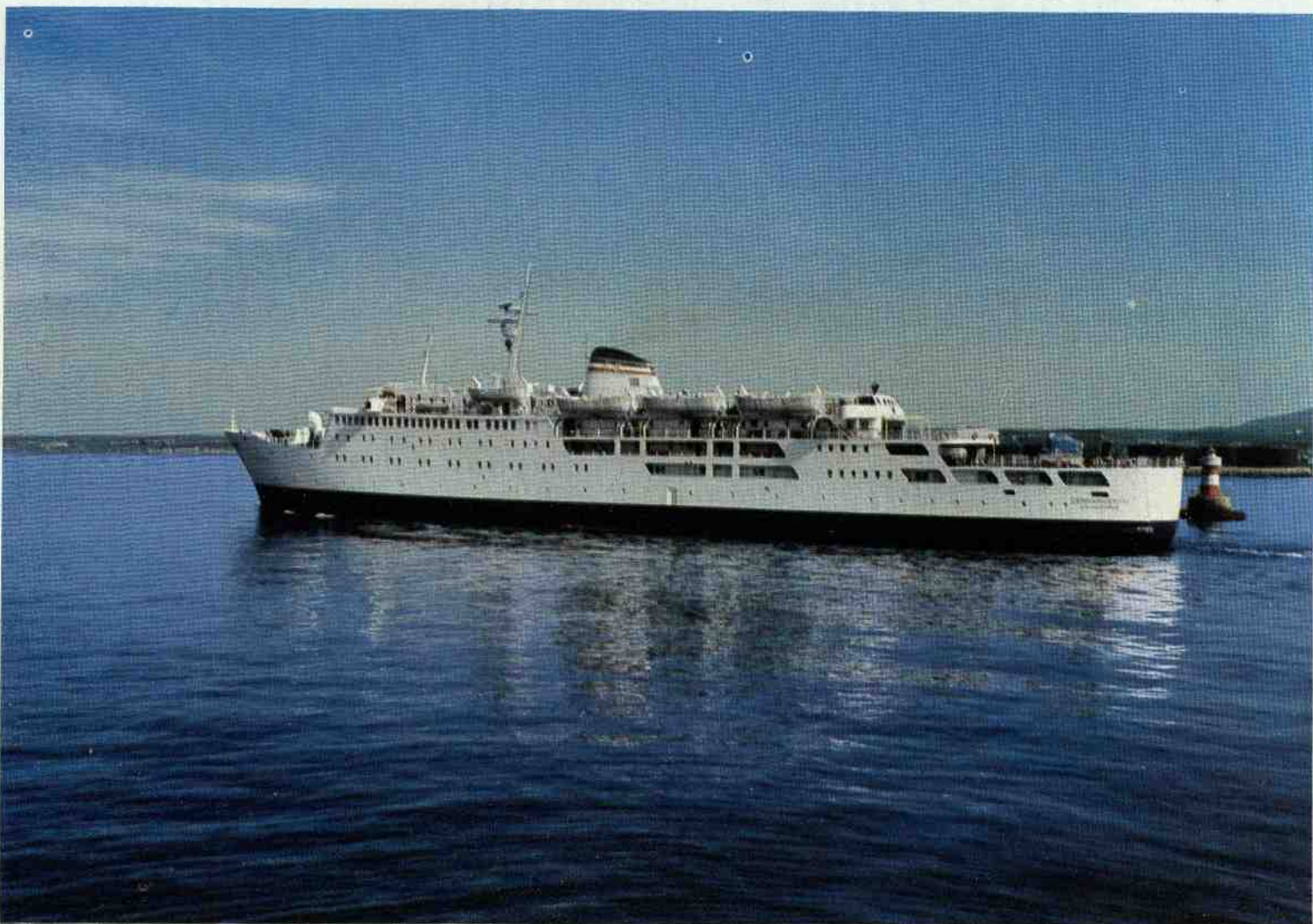
Nave traghetto Gennargentu (Ferrovie dello Stato) equipaggiata con due motori Fiat 606 TS della potenza complessiva di 8000 Cv
