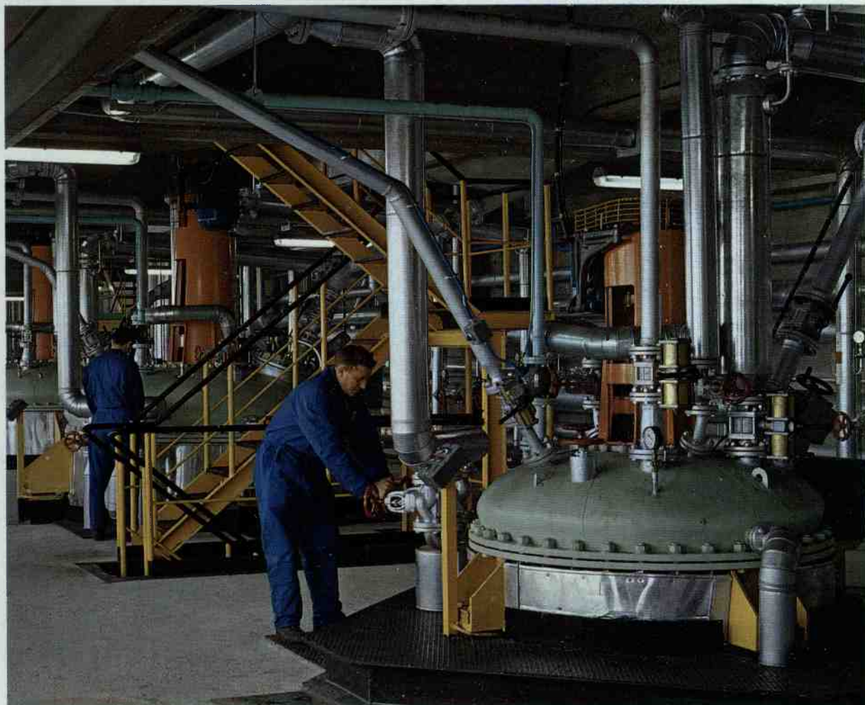
Villastellone (Torino). Nuovo stabilimento Lubrificanti. Impianti di miscelazione e disidratazione sotto vuoto per oli.
