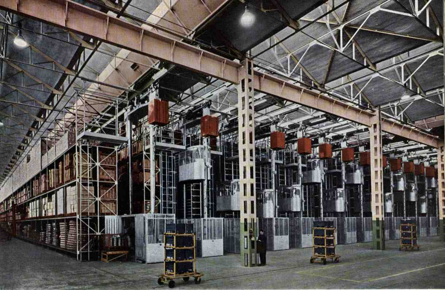
Stabilimento Fiat Ricambi - Vista dei modernissimi scaffali alti 9 metri, lunghi 107, con 160.000 cassette. Ogni scaffale è servito da uno speciale ascensore-traslatore, che lo percorre in tutta la sua lunghezza spostandosi dal basso in alto e viceversa.
