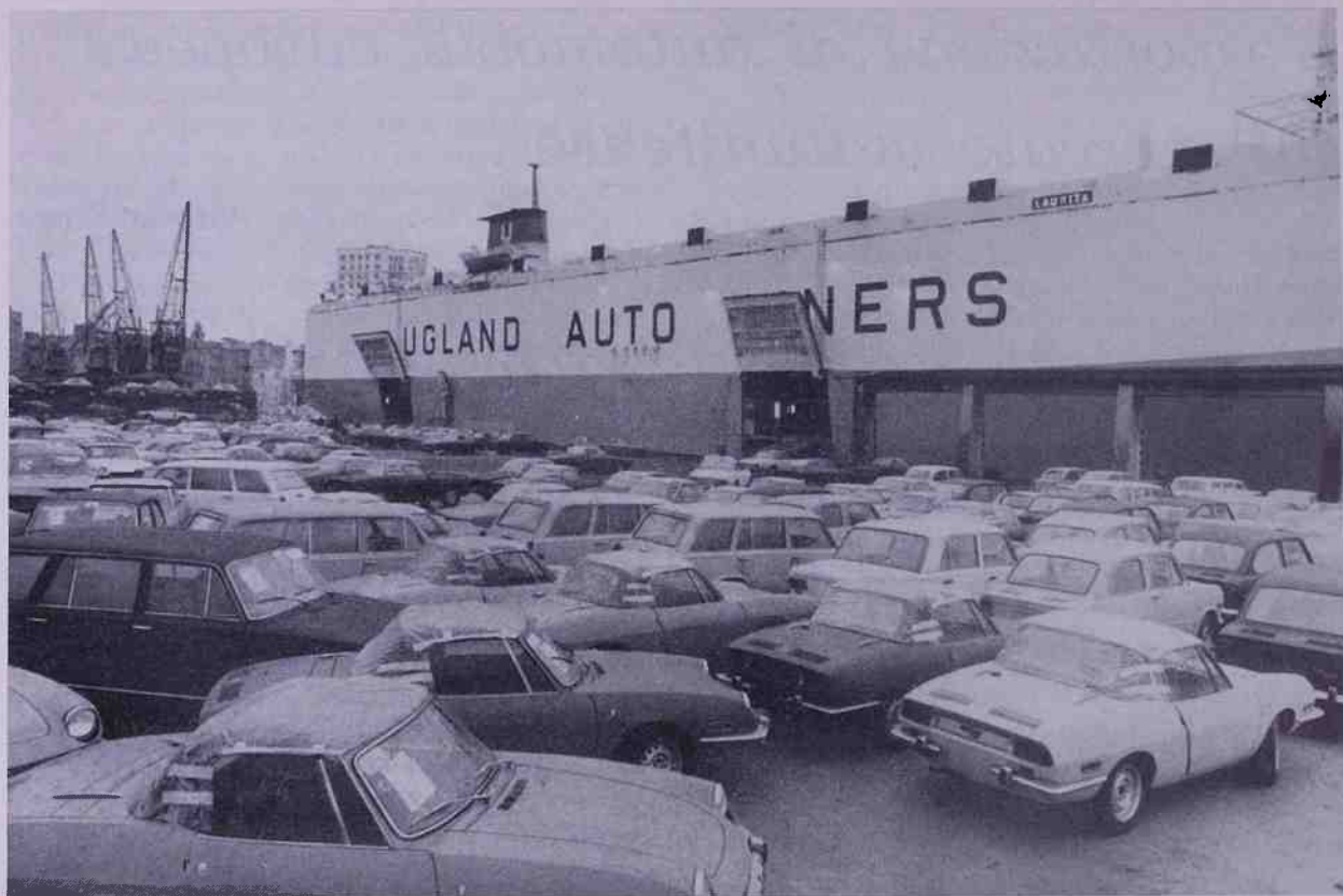
Imbarco di autovetture Fiat sulla motonave « Laurita » nel porto di Savona. La motonave « Laurita », con una capacità di oltre 2800 autovetture e una velocità di 23 nodi, è la prima di tre navi appositamente costruite per il trasporto di vetture Fiat negli USA. È dotata di due portelloni laterali che, abbassandosi sulla banchina, consentono l'entrata delle auto, guidate da portuali specializzati, al ritmo di una ogni trenta secondi, senza impiego di gru, secondo i più moderni orientamenti.
