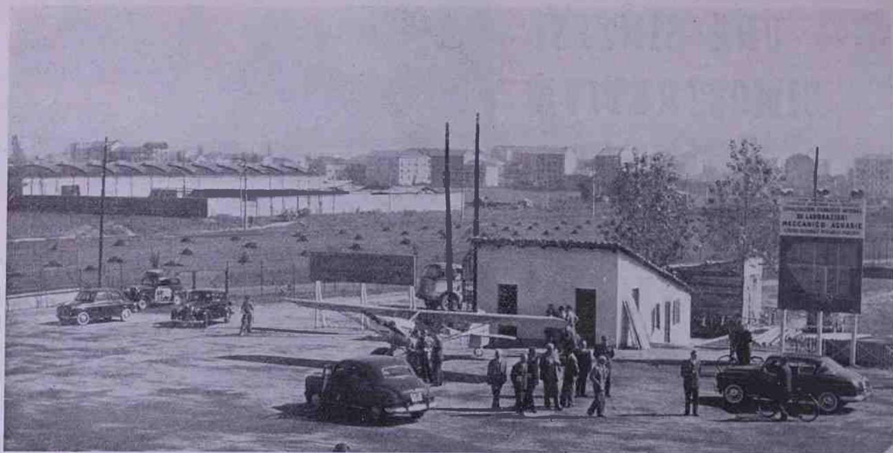
Nuove prospettive nella tecnica agricola; un aereo cingolato, adatto agli atterraggi anche su terreni difficili, da impiegarsi nelle irrorazioni dall'alto.
