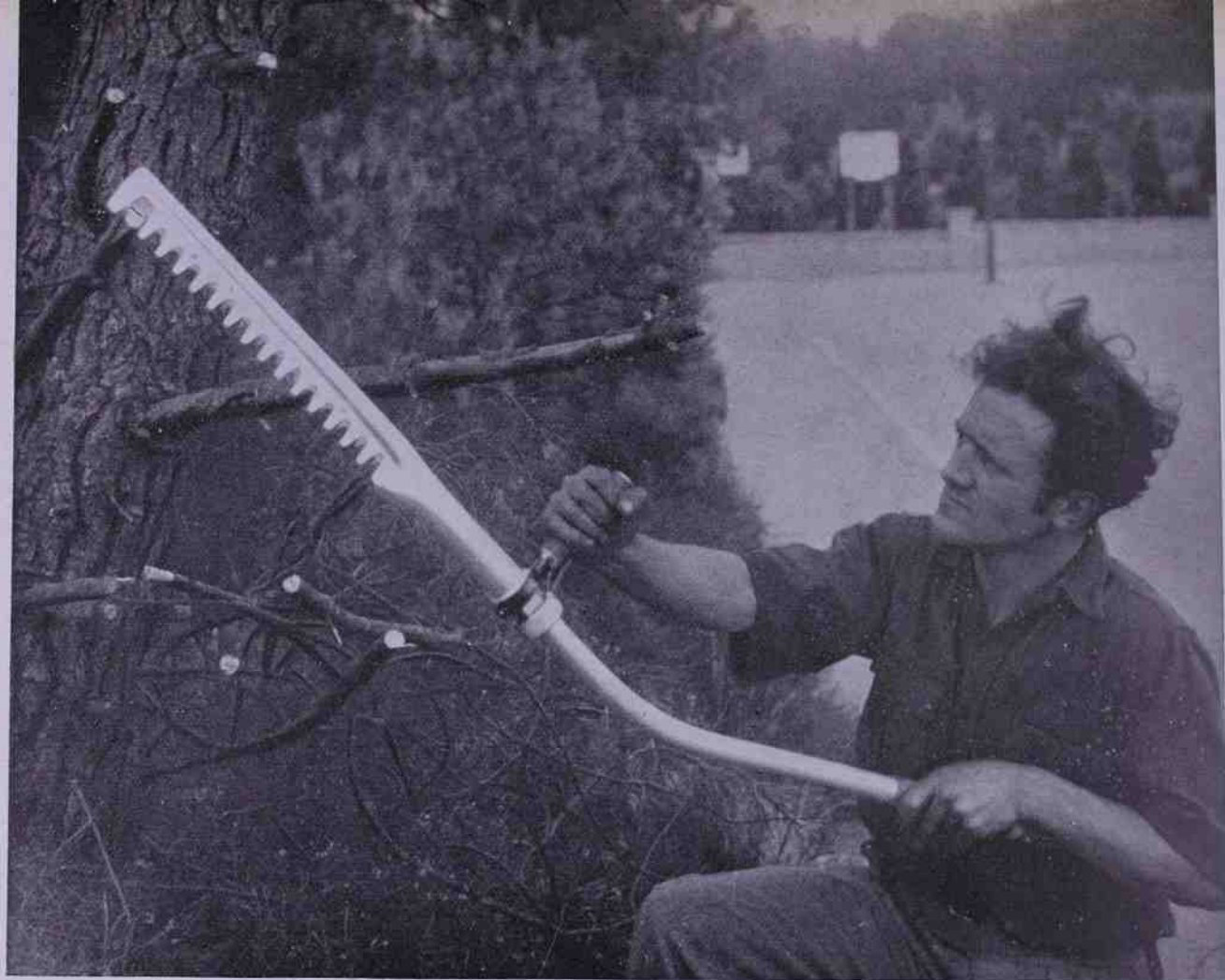
Un nuovo attrezzo ad aria compressa, leggero e maneggevole, per il taglio dei piccoli rami.
