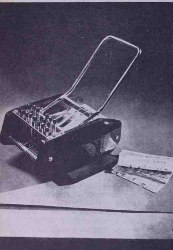
Macchina taglierina: Gli intagli perimetrali della scheda sono eseguiti da una serie di coltelli, alcuni dei quali in figura si vedono sollevati.
