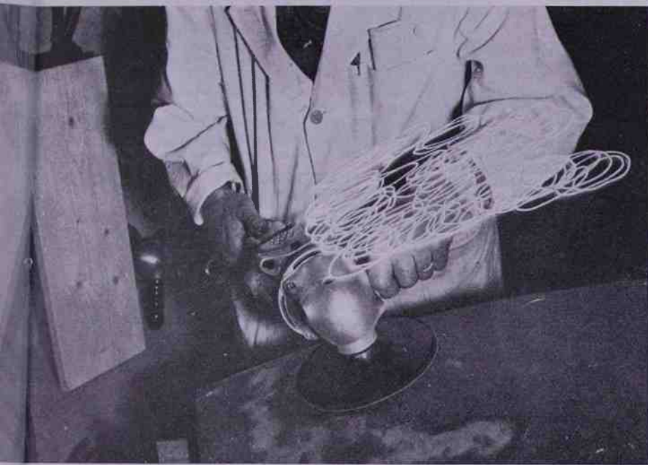
Studio del tempo e del movimento: levigatura di una striscia di metallo con un disco abrasivo.
