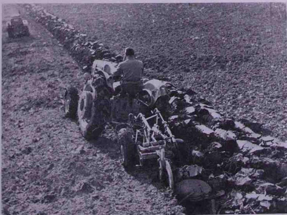
La nuova trattrice FIAT 25 con motore Diesel — 25 HP effettivi, 4 cilindri — 1900 cmc. di cilindrata. Questa cilindrata è pure quella del motore Diesel della Fiat Campagnola e dell'autocarro Fiat 615N. Con questo motore di grande avvenir la Fiat ha così realizzato l'unificazione delle parti, assicurando il vantaggio dei ricambi sempre ed ovunque.
