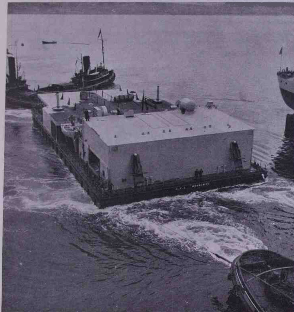
Una centrale galleggiante per le trivellazioni petrolifere sottomarine. La profondità raggiungibile è intorno ai 5000 metri. È costruita per la Shell Venezuelana.
