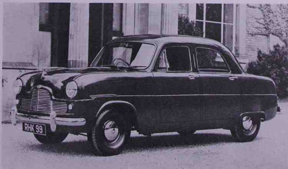
Fig. 13 — La Ford tipo «Zephyr 6» a 6 cilindri, 2262 cc. costruita negli stabilimenti di Dagenham (G. Bretagna).
