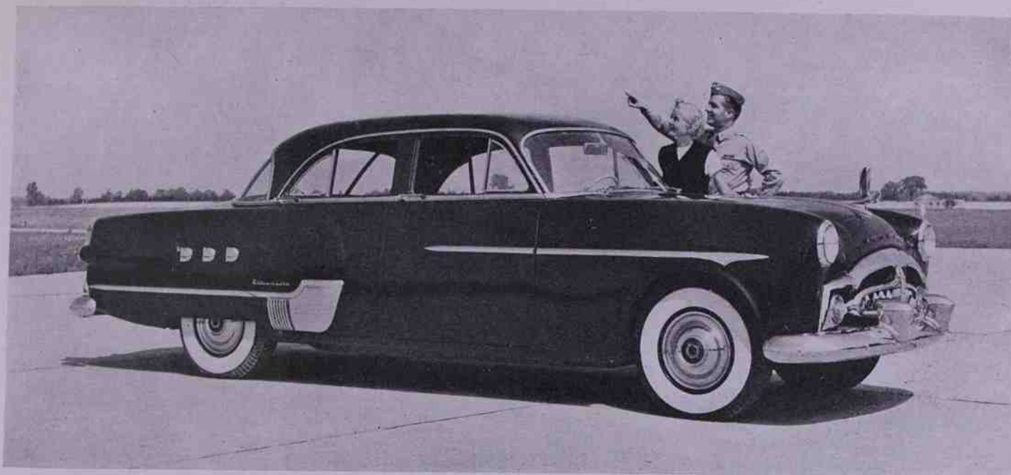
Fig. 15 — La Packard « Patrician 400 » potenza del motore 155 cv., rapporto di compressione 7,8.
