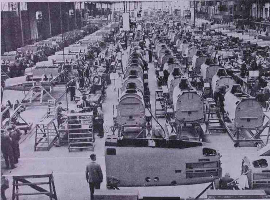
Fig. 2 — Un aspetto della fabbrica di velivoli Gloucester Aircraft a Gloucester (Inghilterra). Una sala di montaggio degli aerei Meteors MK 7, 8, 9, 10.
