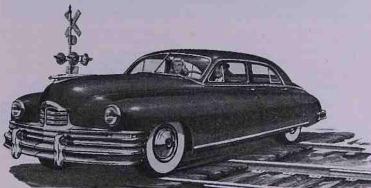
La Packard 1950 (8 cilindri in linea - 150 cv. a 3600 giri/min.) (Packard Motor Car Co.).
