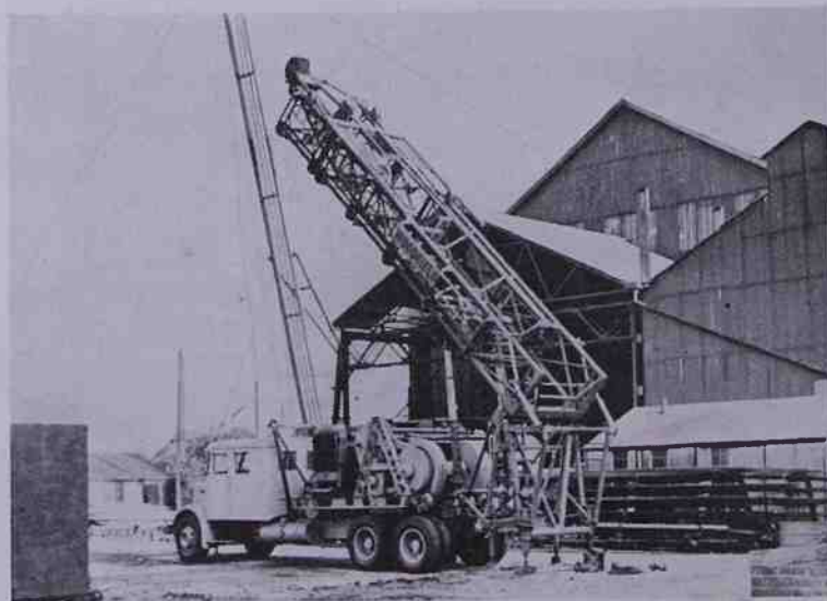
Stazione autotrasportata per la trivellazione (Woodfield Hoist Co.)
