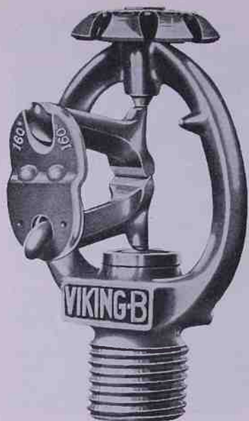
Fig. 7. — Una speciale valvola di sicurezza antincendi: posta in un ambiente, se in questo la temperatura si eleva, la saldatura che unisce la piastrina fonde liberando il tappo e provocando l'uscita di un getto d'acqua. (Viking Corp.).
