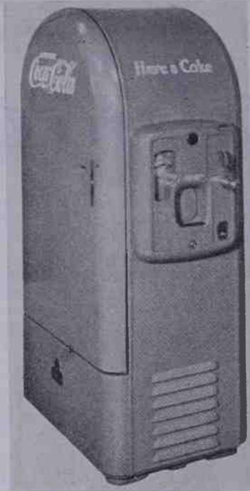
Fig. 4. — Distributore automatico a moneta in lamiera stampata: introducendo la moneta si provoca la discesa del bicchiere di carta che successivamente si riempie della bevanda, la cui temperatura è regolata (Struthers Wells Corp.).
