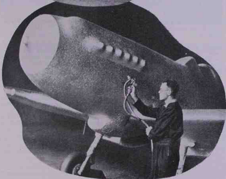
Fig. D) -- Imballaggio protettivo applicato ad un aeroplano. (R. A. Brand & Co. Ltd.).
