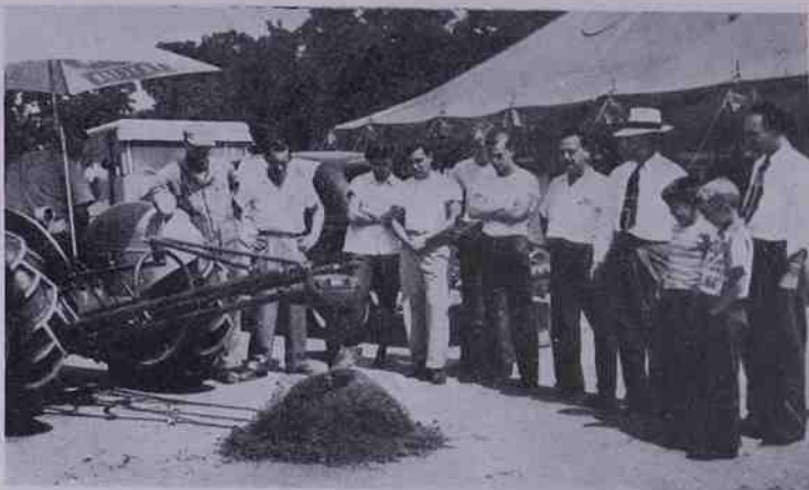
Questa macchinetta — siamo alla Fiera agricola provinciale del Montgomery (Maryland) — in men che non si dica, scava un bel buco rotondo, buono per piantarci pali. E poi ci sono trattori ed aratri, mietitrici e mungitrici automatiche.
