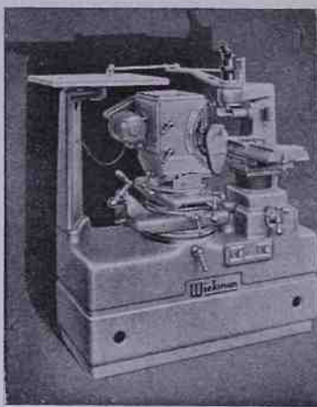
Fig. 17 - Rettificatrice di profili a controllo ottico (Wickman Ltd.).
