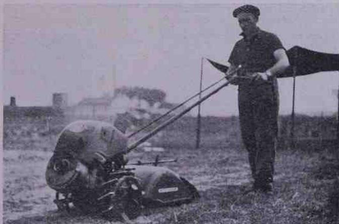
Motocoltivatore SOMUA mod. F 5, di 4 CV, in lavoro di fresatura in pianura.
