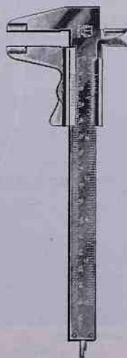
Calibro a corsoio di precisione « SIBUR » - In acciaio inossidabile temperato, con due Nonii - Con punte a coltello per misurazioni interne e becchi per gole - Con asta di profondità.
