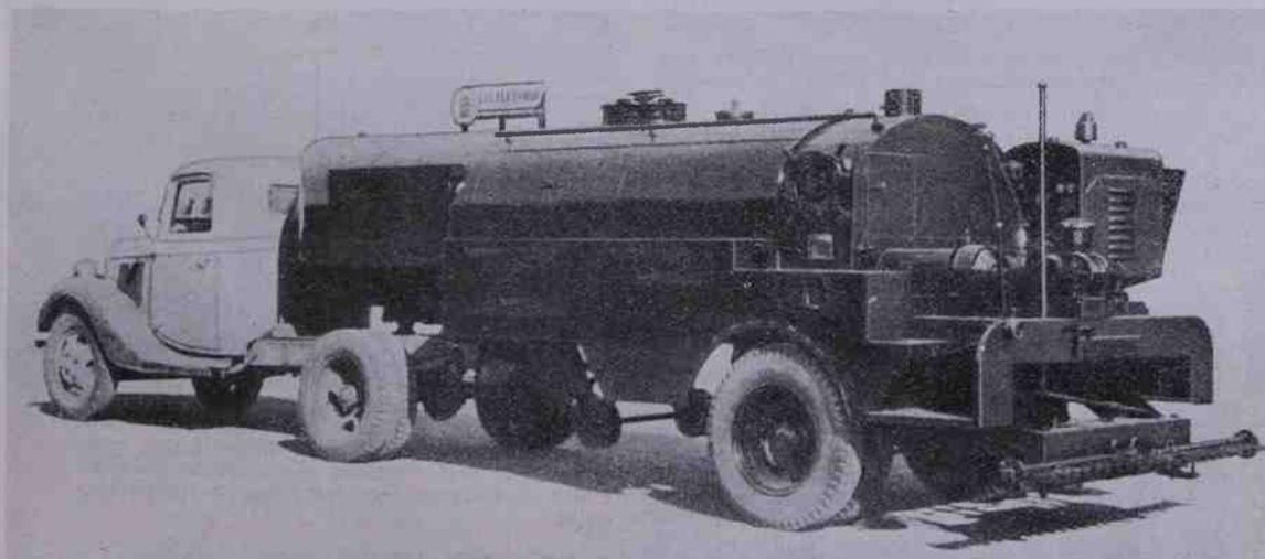
**Fig. 3. - Autocarro cisterna attrezzato per la spruzzatura del bitume. (Littleford Bros. Inc.)**
