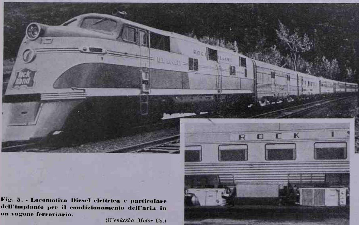
Fig. 5. - Locomotiva Diesel elettrica e particolare dell'impianto per il condizionamento dell'aria in un vagone ferroviario.
