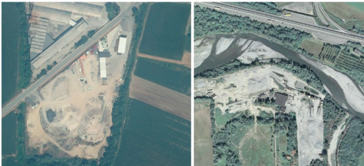
Fig. 8 Foto aerea di due impianti di trattamento. A sinistra vengono trattati rifiuti da demolizione, mentre a destra prodotti da cava
