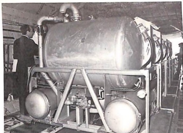
1) I cinque serbatoi modulari del sistema MAFFS, della capacità complessiva di circa 12 m 3 , installati sull'aereo Lockheed C-130. Il sistema completo a bordo ha un peso complessivo a vuoto di circa 5 tonnellate.
