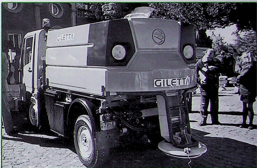
KP 100: spargitore appositamente creato da GILETTA S.p.A. per UNIMOG UX 100 Mercedes
