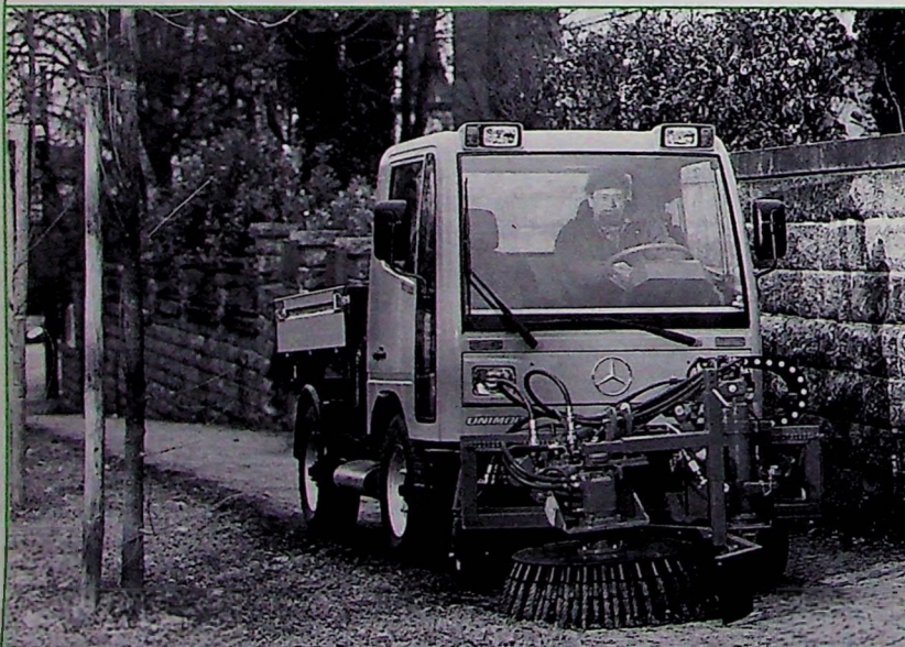
Il nuovo modello Unimog UX 100 si distingue per la sua compattezza: larghezza idonea ai marciapiedi, altezza conforme ai parcheggi sotterranei
