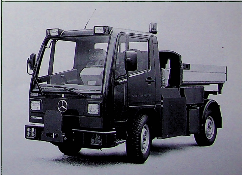
Unimog UX 100 con motorizzazione ibrida: dispone infatti di due motori, uno diesel e l'altro elettrico.
