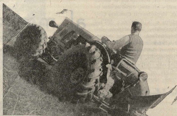
Trattrice SAME a quattro ruote motrici in lavoro di aratura con forte pendenza
