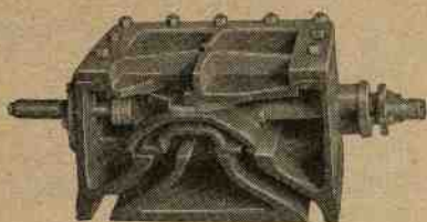
14. Stantuffo per macchina a vapore (scala 1/2).
