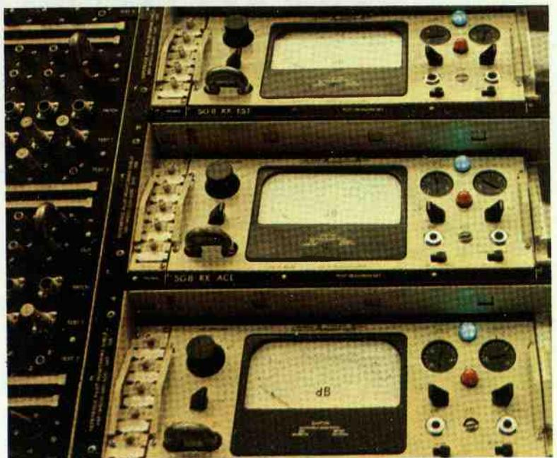
Misuratori delle frequenze pilota di gruppo secondario del Sistema MAT-1
