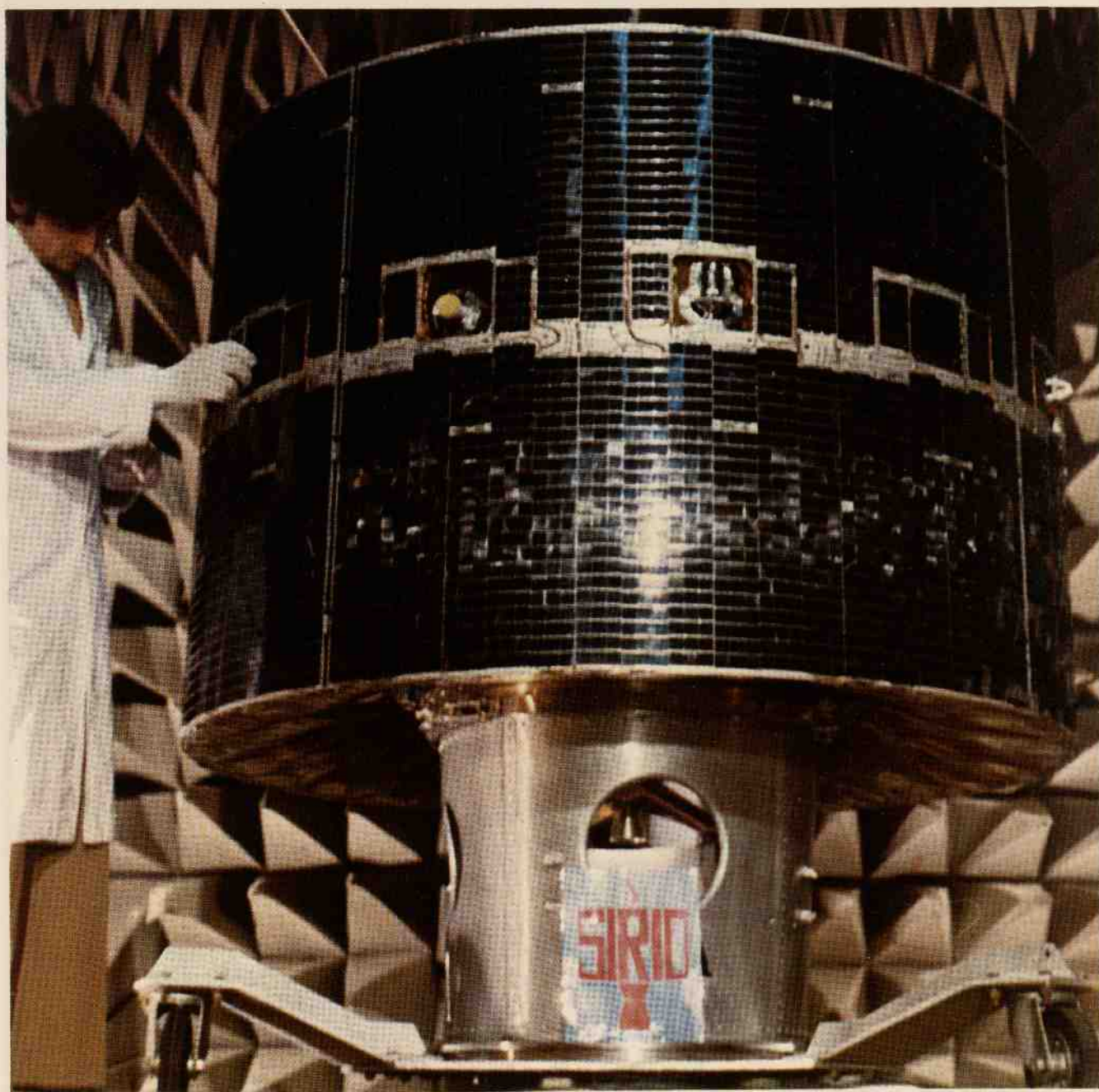
Satellite Sirio - Durante le prove a Radio-Frequenza effettuate presso i laboratori della Compagnia Industriale Aerospaziale
