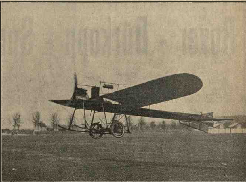
Il monoplano Hanriot, munito di motore Miller 40 HP, vola sull'aerodromo di Reims.
