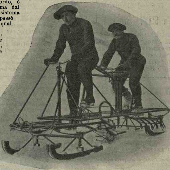
La slitta del luogotenente De La Besse. — una specie di tandem basato su quattro pattini e che marciava per mezzo d'una ruota dentata che mordeva la neve...
