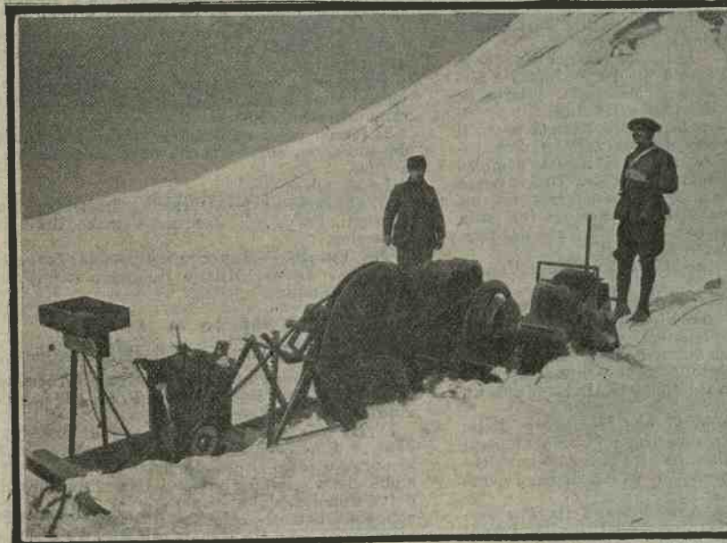
Il mastodonte inolese. La ruota del centro delle slitte di Barnes, Scott e O. è meno pesante e massiccia ma il veicolo inglese è assai più grosso di quello francese.
