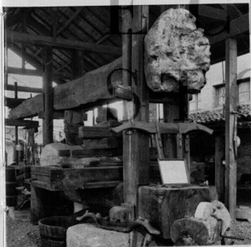
Tre tipi di torchi storici esposti al Museo Bersano delle contadinerie (Nizza Monferrato): il torchio latino (seconda metà del secolo XVII), quello a sportello (circa 1700) e quello a due viti capovolte e fisse detto « alla genovese » che segna l'inizio del torchio moderno.
