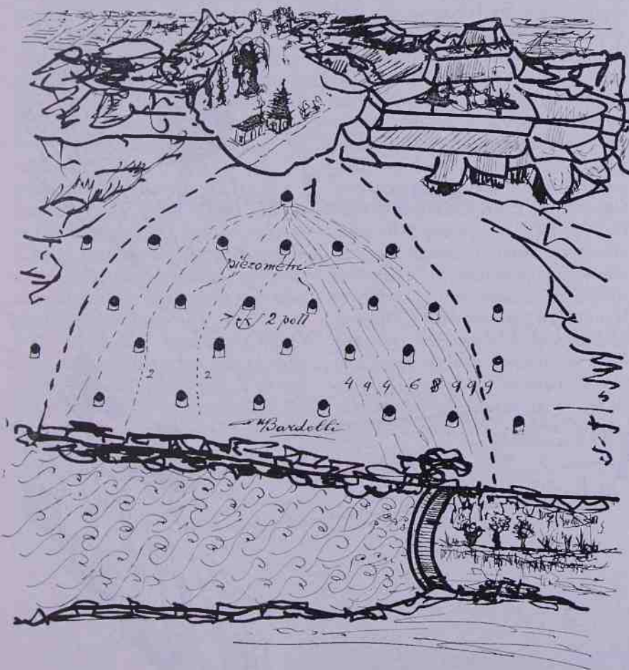
Fig. 2 - In basso la diga ad arco ed a sinistra il lago artificiale. La sponda di tale lago è soggetta ad una lunga compagine di strati molto pendenti e che danno sospetto di franosità. Infatti nella parte superiore del monte sono visibili strati rocciosi solidi ed immobili. Poi, più in basso la natura cambia. Nella parte centrale si sono rappresentati i pozzetti piezometrici che si trovano sia nella parte soggetta alla frana — la quale tuttavia non si è ancora manifestata — ed anche ai suoi lati. Il pozzetto n. 1 (sono tutti pozzetti da due pollici di diametro e profondi qualche metro, soltanto per raggiungere le acque freatiche) è il più elevato topograficamente. In esso si versa acqua molto salata. Il moto naturale delle acque freatiche sposta tale acqua salata e nei pozzetti sottoposti, sempre topograficamente, si prelevano i campioni che all'analisi ci danno i quantitativi di sale in parti per milione che sono percolati dal pozzo n. 1. In tal modo è possibile tracciare le linee di migrazione delle acque sotterranee e vedere dove si accumulano ossia dove le portate sono maggiori. Se repentinamente abbiamo un accentuarsi del moto delle acque sotterranee verso una data zona si deve temere che colà si manifesti la frana, specialmente se il letto di tali acque è costituito da strati argillosi o comunque lubrifici. Sulle linee di migrazione delle acque sono segnati i quantitativi di sale in parti per milione. Si nota che i numeri maggiori ossia le salinità maggiori sono localizzate a destra della figura, e pertanto la frana che colà avrebbe tendenza a manifestarsi colpirebbe la diga, parte del bacino e parte fuoruscirebbe a destra. Opportuni drenaggi in lato per impedire alle acque di infiltrarsi probabilmente salverebbero il bacino dalla frana.
