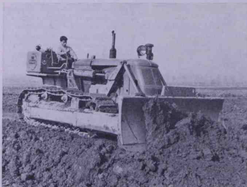
Angledozer profeso al livellamento dei terreni smussando le prominente e colmando le depressioni.
