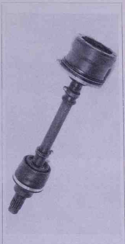
Giunto omocinetico per la trazione anteriore su « Flavia » e « Fulvia ».
