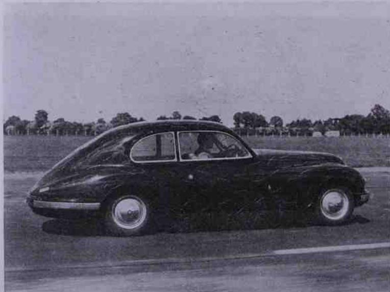
Fig. 2 — Un metodo di prova delle caratteristiche aerodinamiche della vettura Bristol. Alla carrozzeria sono stati attaccati pezzi di lana che si orientano col moto della vettura secondo la direzione del flusso d'aria.
