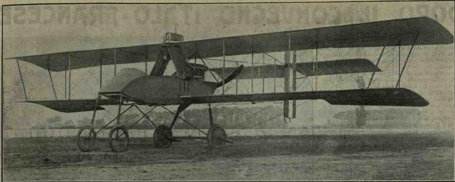
Nell'ultimo numero abbiamo annunciato il « record » battuto dal pilota aviatore militare Antonacci. Egli è salito con due passeggeri alla quota di 4250 metri, pilotando un apparecchio SIT, licenza « Voisin » munito di un motore « Isotta Fraschini » HP 140-160. — La nostra fotografia riproduce appunto questa magnifica macchina del volo che la ormai potente Casa SIT, ha modificato nell'installazione del nuovo motore fisso.
